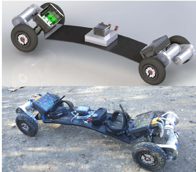
Abbildung 7.15: Konzept und Fotografie des E-Mountainboards EpOS
